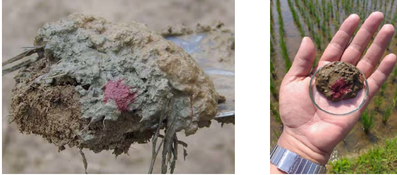
Gambar 7. Teknik Penetapan Kondisi Reduksi Besi pada Tanah Sawah. Keterangan: Warna merah muda pada bidang bongkah contoh tanah timbul seketika setelah ditetesi dengan larutan \alpha, \alpha' -Dipyridyl 0,2% yang menandakan tanah sawah tereduksi kuat.
